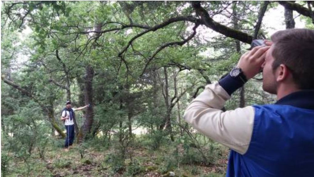
Figura 173: Operazione di misurazione dell'altezza delle piante in campo mediante ipsometro
