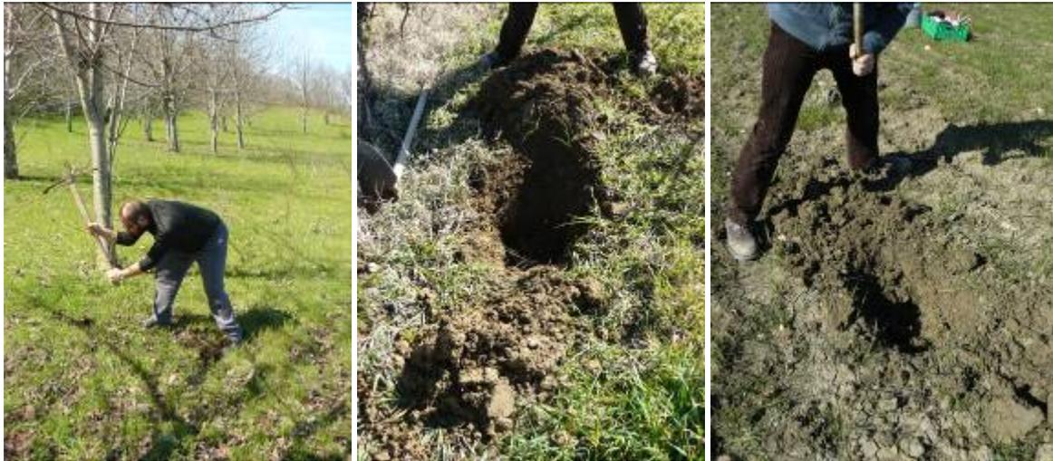
Figura 51: Operazioni di apertura minipit
