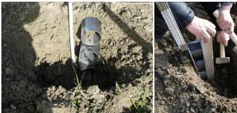
Figura 52: Operazioni di prelievo fustella per determinazione della densità apparente all'interno del minipit
