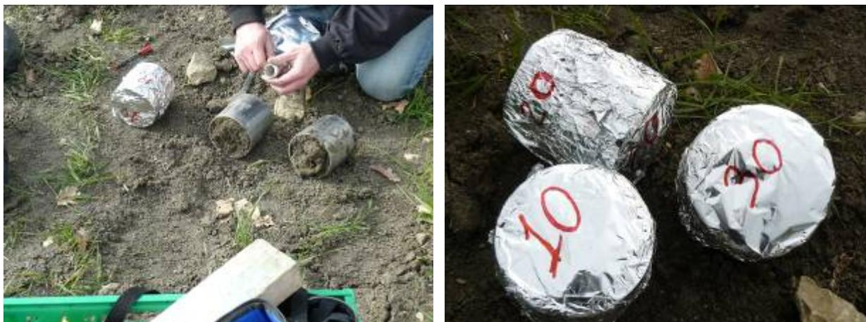
Figura 54: Operazione di raccolta e codificazione delle fustelle prelevate
