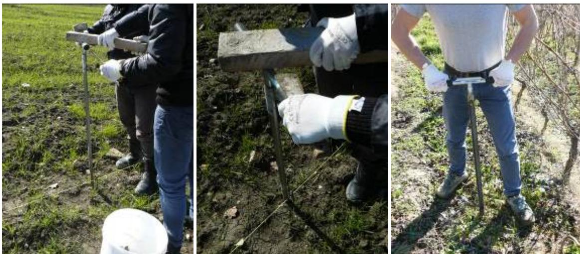
Figura 48: Operazione di campionamento suolo mediante sgorbia manuale
