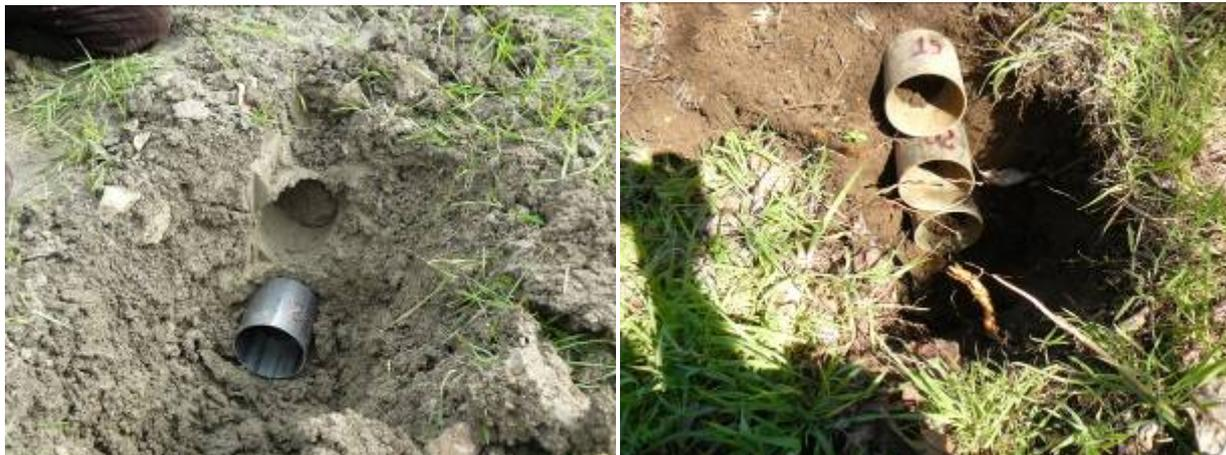
Figura 53: Operazioni di prelievo fustella per determinazione della densità apparente all'interno del minipit
