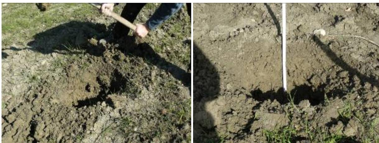
Figura 50: Operazioni di apertura minipit
